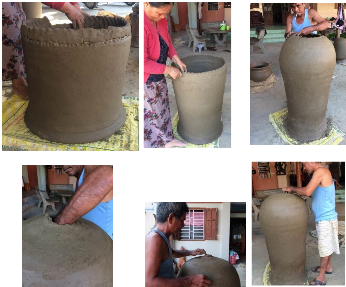
Hình 6. Thực nghiệm chum theo cách làm phần miệng trước, làm đáy sau
