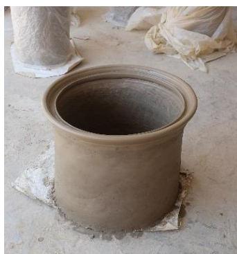
Hình 5. Thực nghiệm chum bằng cách sử dụng khuôn dưới đáy
