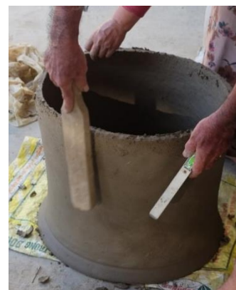
Hình 5. Thực nghiệm chum bằng cách sử dụng khuôn dưới đáy
