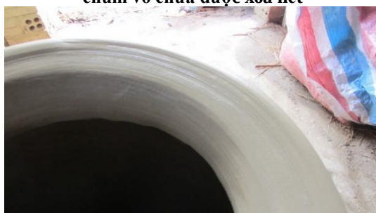
Hình 11. Những vết ghép con chạch trong lòng chum vò chưa được xóa hết
